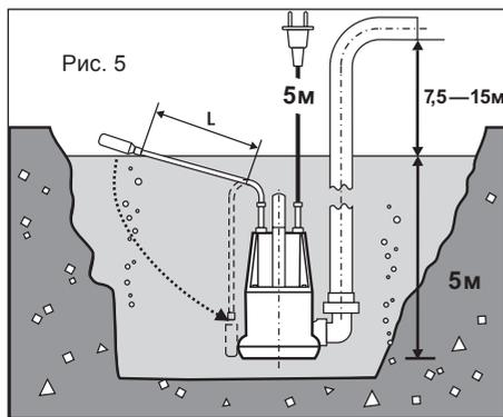
**ПРИМЕЧАНИЕ!** Уровни включения и выключения насоса регулируются **ОДНОВРЕМЕННО**. При установке определенного верхнего уровня (включения насоса) убедитесь, что в нижнем положении выключатель обеспечивает своевременное (до оголения водозаборных отверстий в нижней части) выключение насоса.
