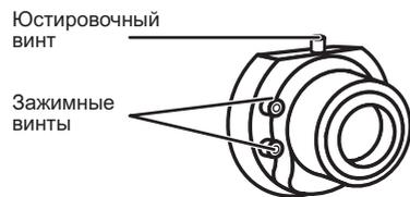
4. Если разность между  $b2'$  и  $b2$  положительна (отрицательна), горизонтальная нить должна быть поднята (опущена). Чтобы поднять/опустить горизонтальную нить, закрутите/открутите юстировочный винт. Определите новое значение разности  $b2'$  и  $b2$  и, в случае необходимости, повторите юстировку.
