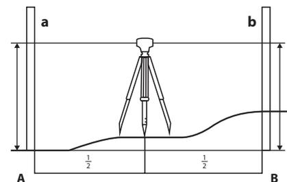
1. Разбейте расстояние на несколько секций и определите превышение для каждой секции.
