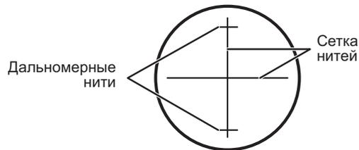
2. Значение эквивалентно расстоянию в метрах между рейкой и инструментом. Пример: Если равно 32 см, то горизонтальное положение от центра инструмента А до рейки В составляет 32 м плюс постоянная поправка дальномера (32 м + 100 мм).
