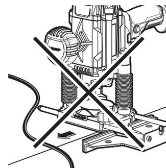
Избегайте попадания сетевого кабеля в зону работы фрезы
