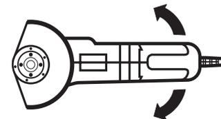
Изделие с раскручивающимся или останавливающимся диском обладает повышенным боковым крутящим моментом. Не выпускайте его из рук при запуске и выключении до полной остановки диска
