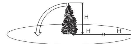
Перед началом валки дерева определите естественный наклон дерева и направление ветра, а также оцените расположение наиболее тяжелых веток и, с учетом этих факторов, определите направление падения дерева. Примите меры, чтобы в направлении его падения не находились люди, животные, линии электропередач, телеграфные провода, строения, техника и иные повреждаемые объекты.
