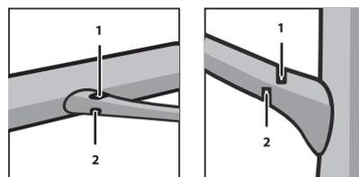
При опиливании веток, не находящихся под натяжением, сначала следует надпилить со стороны, в которую будет отпадать ветка, затем отпиливать с противоположной стороны. При отпиливании тонкой ветки пазы могут совпадать, при отпиливании толстой – обязательно иметь смещение.
