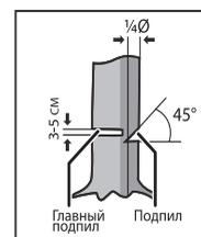
б) Выполните чуть выше основной пропил со стороны, противоположной подпилу, на глубину 3/4 толщины ствола, обязательно оставив небольшой недопил.
